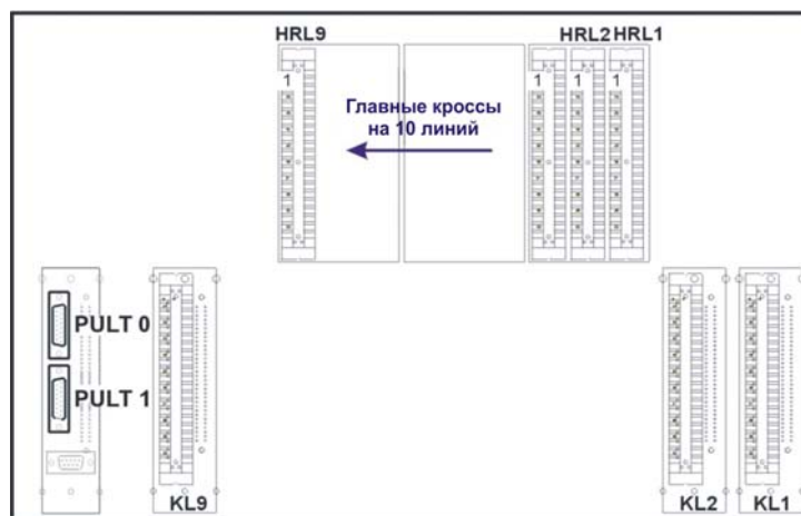
Рис.3.3. Размещение разъёмов на задней панели шкафа 19" RACK
