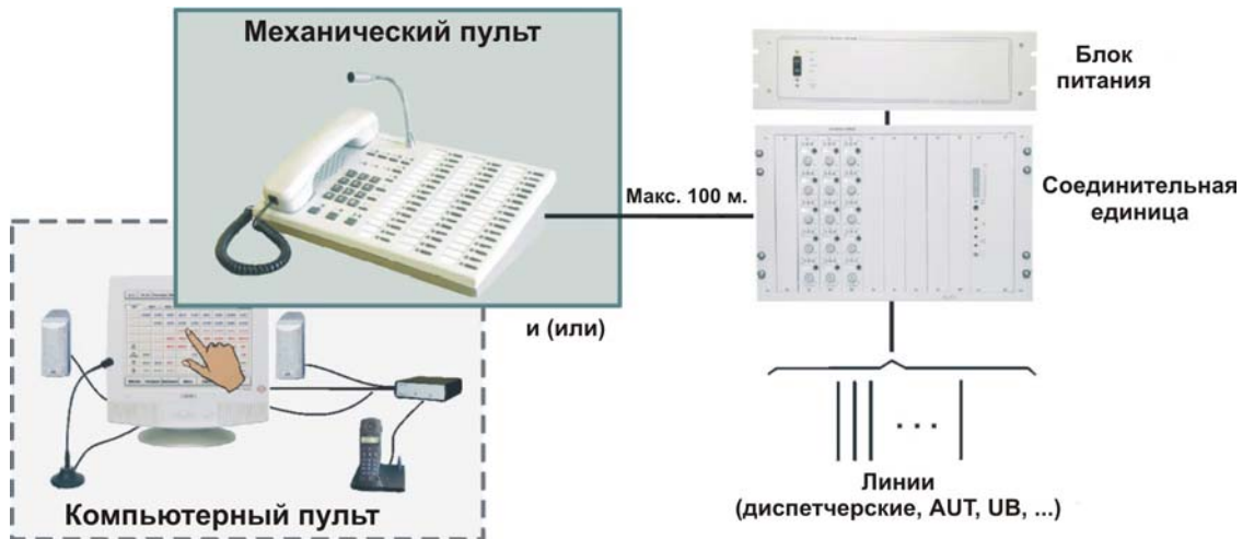
Рис. 3.1 Блочная схема построения коммутатора ALFA
