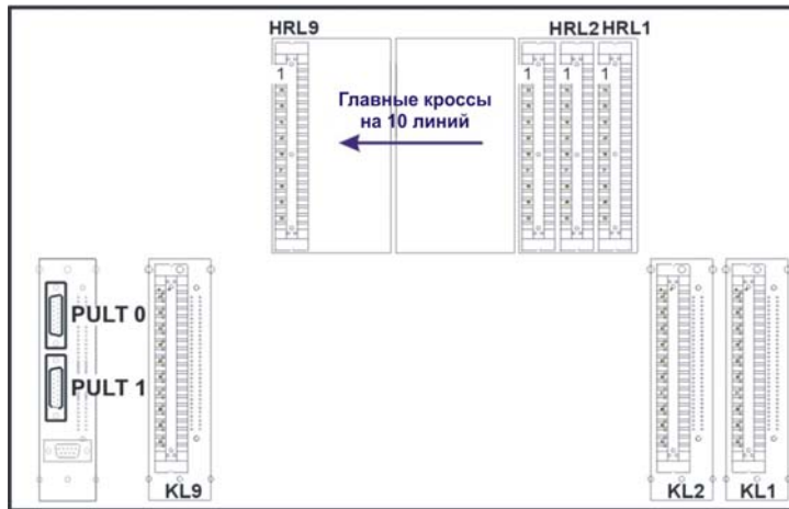
Рис.3.3. Размещение разъемов на задней панели шкафа 19" RACK.
