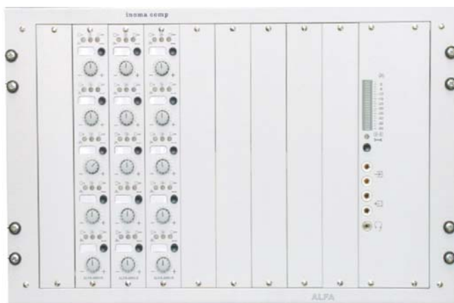
Рис. 3.1 Соединительная единица «ALFA-SJ-KRE» с установленными платами(вид спереди).
